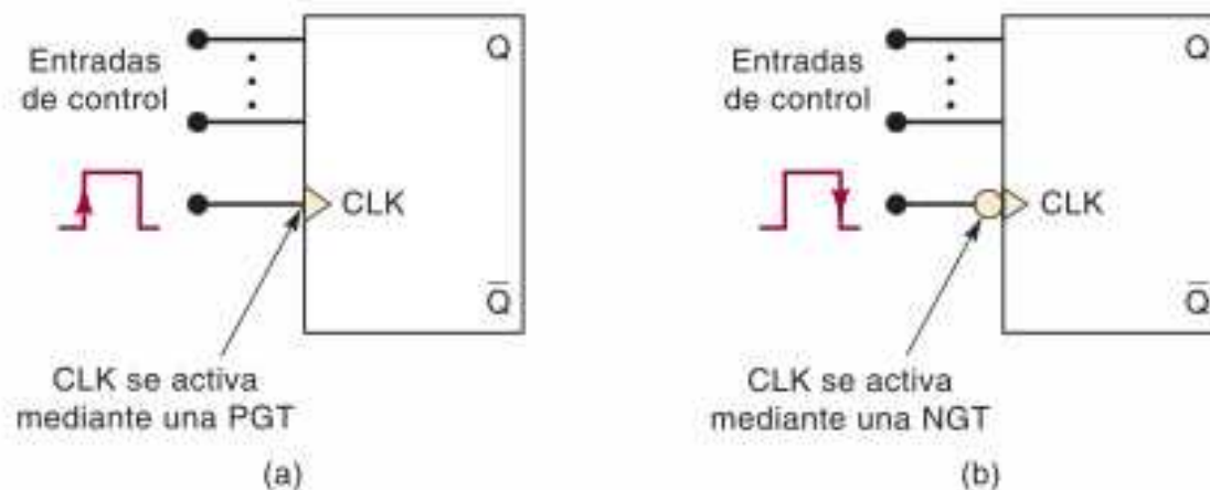
FIGURA 5-17 Los FFs sincronizados por reloj tienen una entrada de reloj ( CLK ) que se activa ya sea en (a) la PGT o (b) la NGT. Las entradas de control determinan el efecto de la transición activa del reloj.
